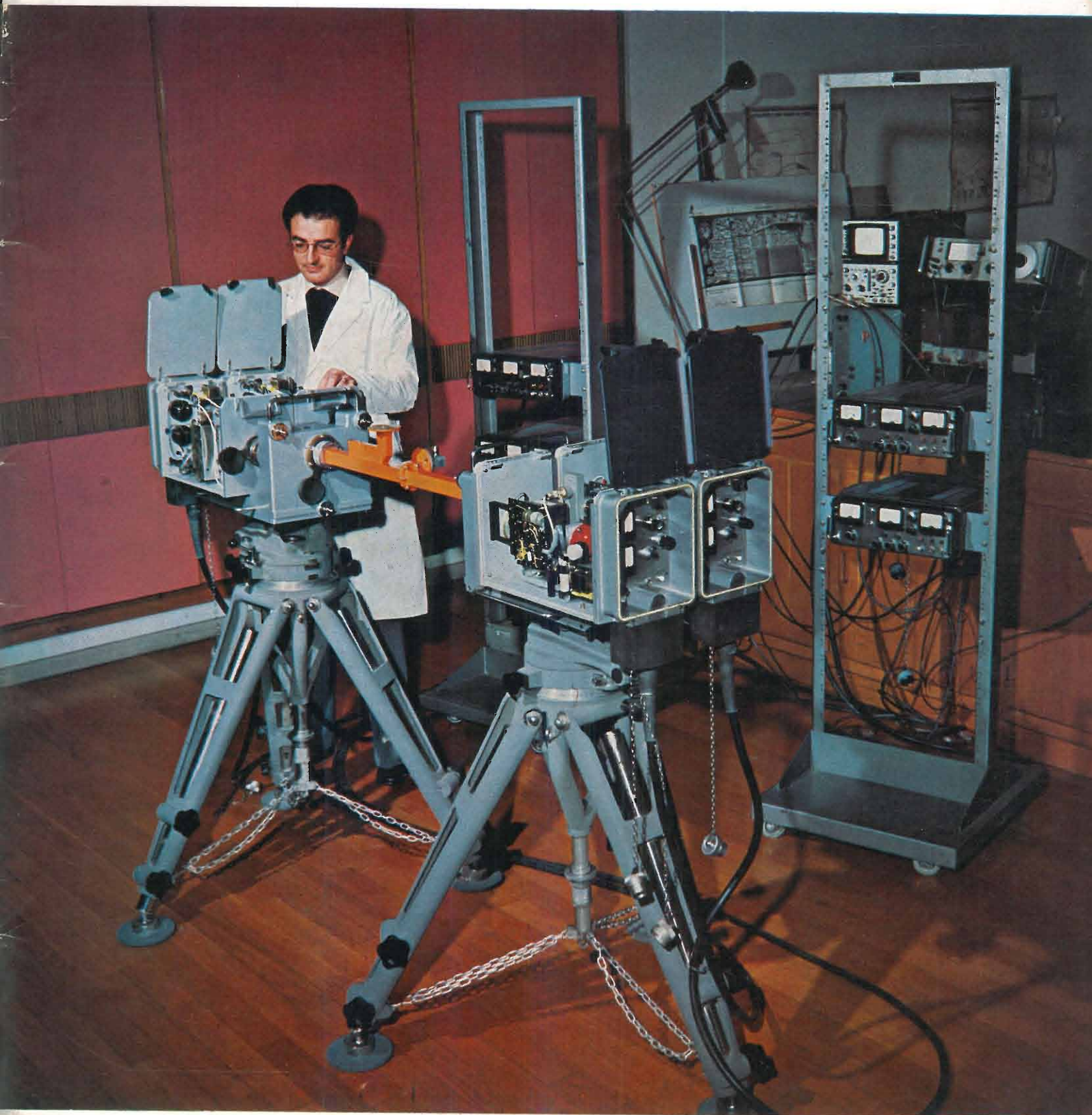
Ponte radio doppio di tipo portatile, per riprese esterne TV anche a colori (v. pag. 80).
