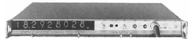
Modello 6316B misura frequenze direttamente da c.c. a 18 GHz.
