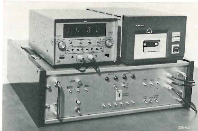
Generatore delle coordinate temporali dei bit errati sul quale sono collocati un "data tester" a sinistra e un registratore a nastro magnetico, a destra.
